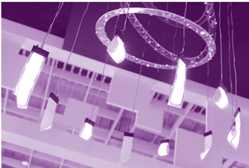
▲ 工研院 FOLED 技術，開發出輕薄、可撓曲的新世代照明元件
